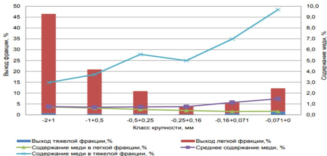
Рисунок 5 – Фракционный состав и содержание меди в различных фракциях пробы исходной руды
