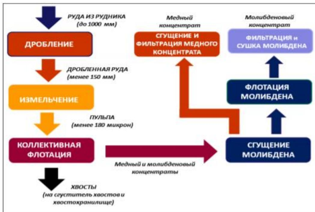
Рисунок 2 – Технологическая схема переработки руд на обогатительной фабрике Актогай
